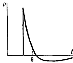
Рис. 5. Форма импульса давления, излучаемого при захлопывании пузырька.
