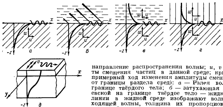
Схематическое изображение поверхностных волн различного типа (сплошной штриховкой обозначены твёрдые среды, прерывистой — жидкость; x —
