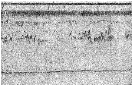
Рис. 2. Типичный вид записи рекордера эхолота (каретка рекордера при записи двигалась вертикально).
